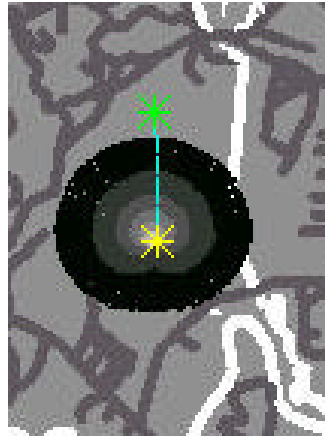
Figura 16: resultado do cálculo de caminho mínimo. Foram percorridos 2171 metros em 1 hora e 2 minutos, com velocidade média de 2110m/h.
